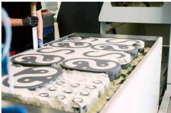
När formdelarna är utskrivna i 3D-printern avlägsnas lös sand.
