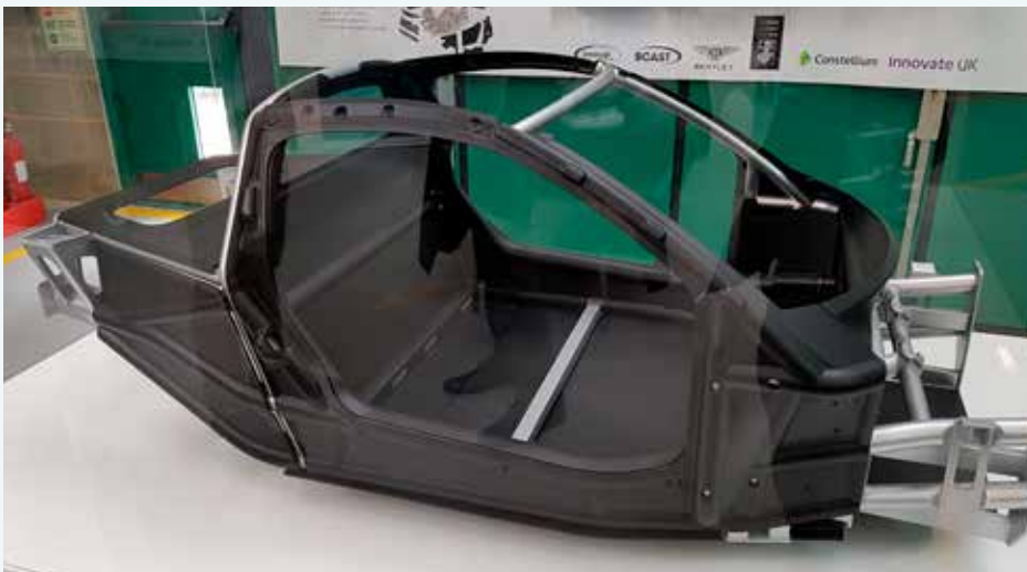
En hybridstruktur i komposit och aluminium för framtida fordon.
