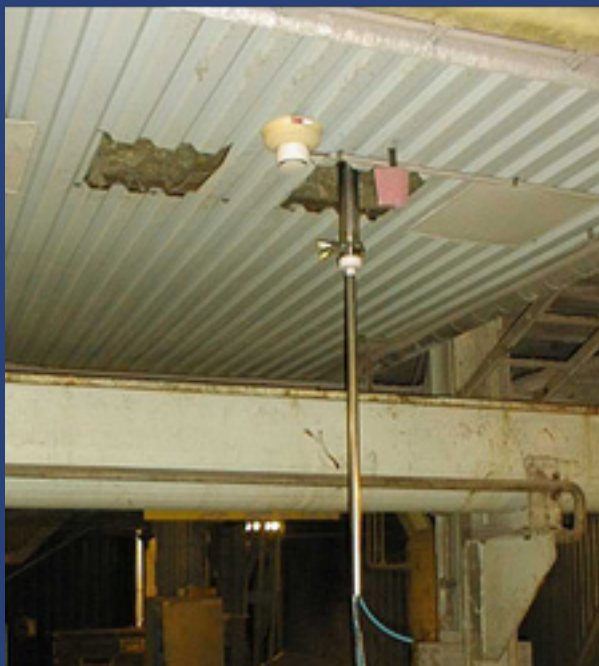
Till rökgas kanal inkopplad utrustning för mätning av syradagpunkten.
