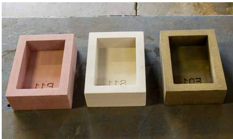
De tre 3D-printade formarna tillverkade i fenol, vattenglas och furan.
