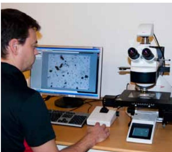
Leica QClean-systemet mäter automatiskt partiklarna som finns på ett filter.
