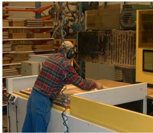
Vänstra utkastskyddet går ner vid byte av arbetsstycke. Produktion pågår i högra halvan.
