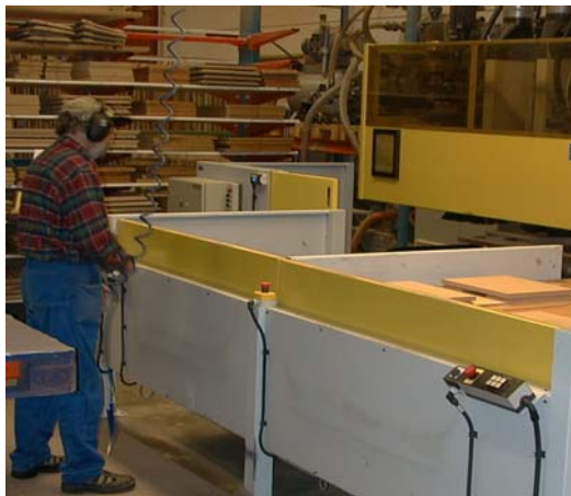
Utkastskydden är i skyddsläge för båda bordshalvorna.
